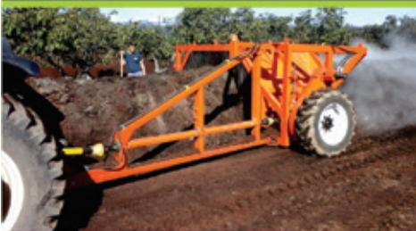
Equipos para compostaje aeróbico
